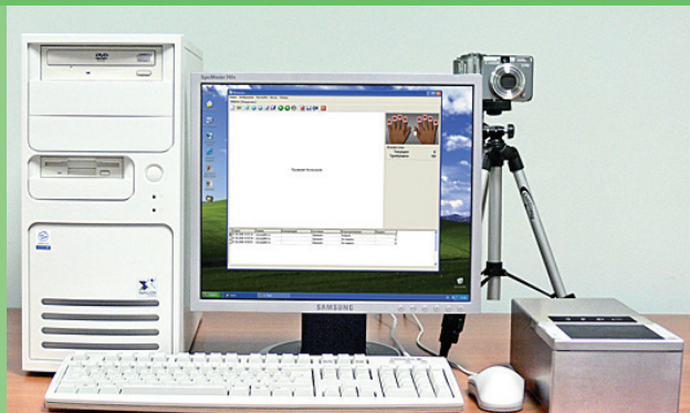
Настольный комплекс электронного дактилоскопирования и оперативных проверок с пальцевым сканером Папилон ДС-30Н
