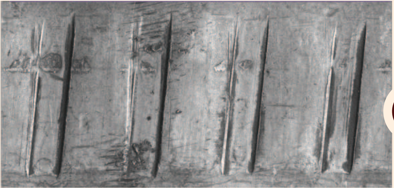
Двухмерное изображение развёртки пули, доступное для исследования сразу после окончания сканирования
