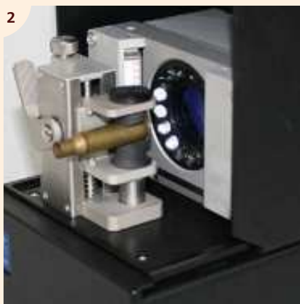
1 Позиционирование пули для сканирования боковой поверхности 2 Позиционирование гильзы для сканирования доннышка
