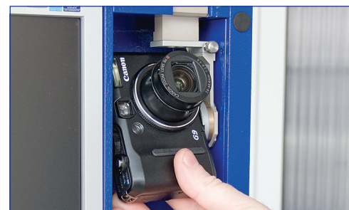
Регулировка угла поворота фотоаппарата – настройка на рост человека.
