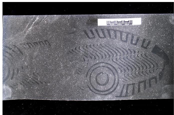
Съёмка пылевого следа отслоения по методу тёмного поля с использованием стола-шахты.
