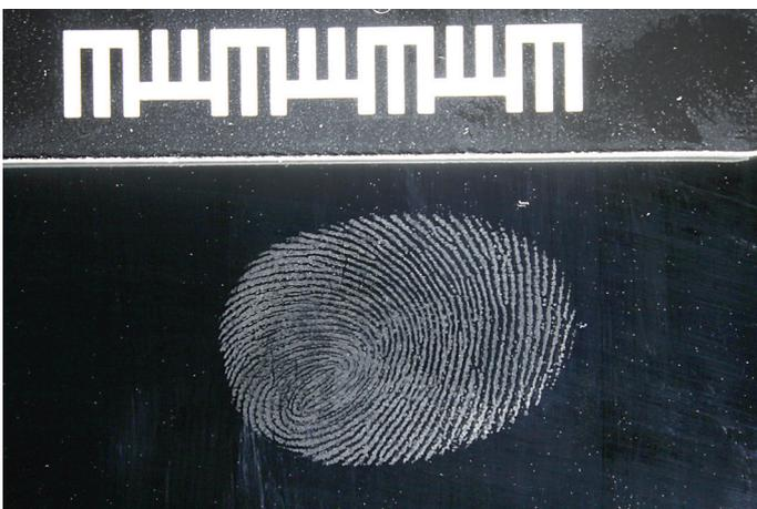
Съёмка необработанного следа по методу тёмного поля с использованием стола-шахты.
