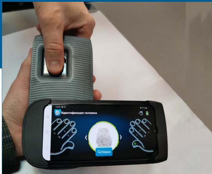
Терминал ДиПП-7 представляет собой ударопрочный блок разработки ПАПИЛОН, соединённый поворотным механизмом со смартфоном.
